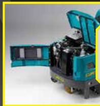
Puede accederse fácilmente a todos los órganos mecánicos internos para las operaciones de mantenimiento, ya que los paneles posteriores, laterales y superiores pueden abrirse completamente. Las baterías (versión EB) pueden ser sustituidas fácil y rápidamente gracias a los rodillos de deslizamiento situados en el fondo del contenedor.
