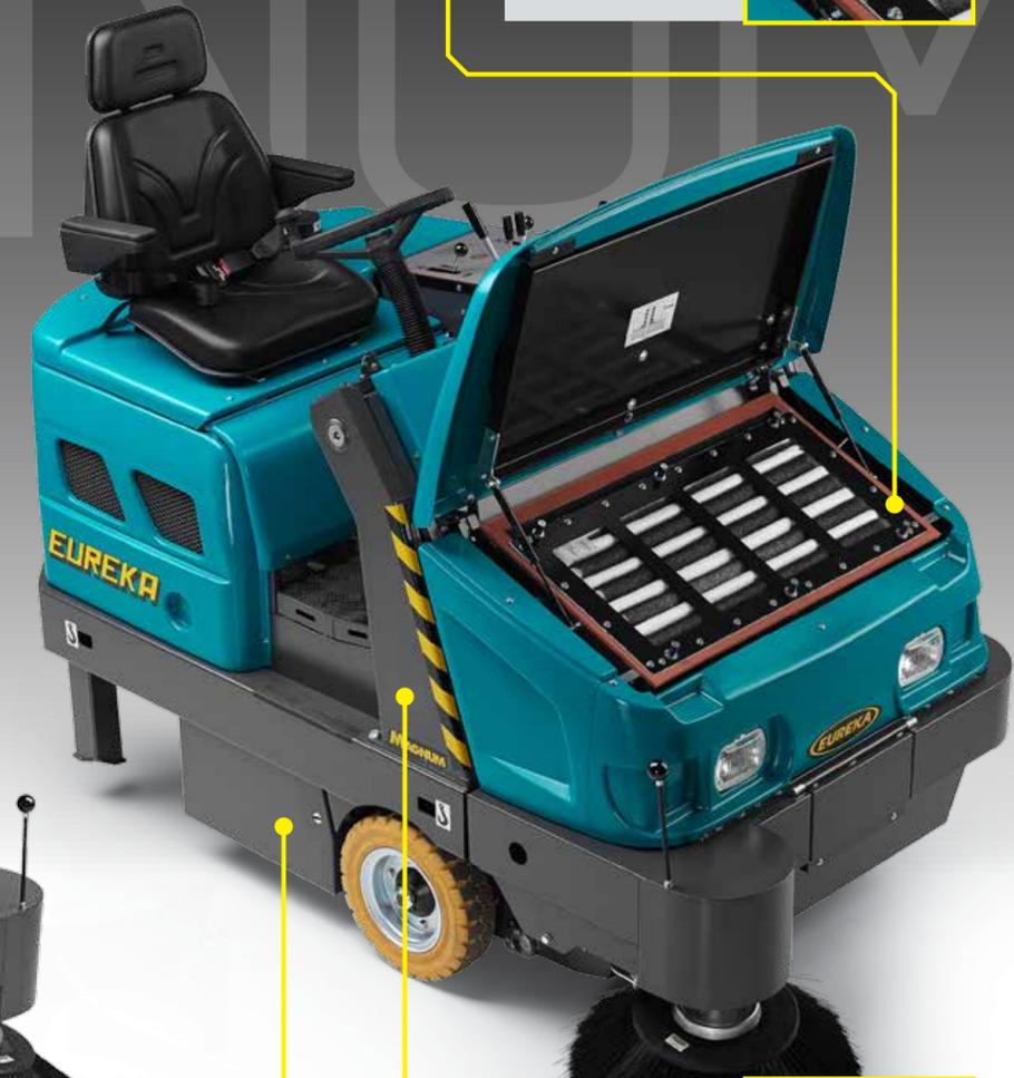
El cajón de basura está situado frontalmente y puede ser elevado hidráulicamente hasta 1.540 mm del suelo. El cajón es flotante y se regula automáticamente, permitiendo una recogida muy simple incluso de los residuos más voluminosos.
